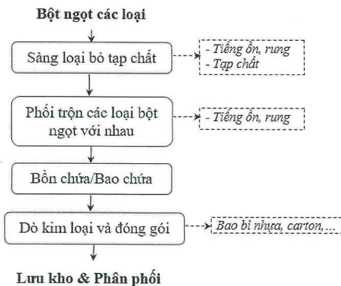
Hình 1.10. Sơ đồ quy trình công nghệ sản xuất bột ngọt.
